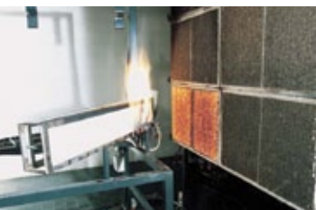
A2) La fiamma, senza protezione, raggiunge il legno.
