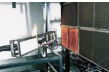
A3) Il pannello è ormai carbonizzato al 50%
