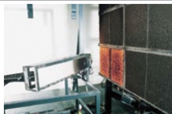
B2) Ha inizio la combustione ma la propagazione della fiamma è molto rallentata dalla verniciatura ignifuga.
