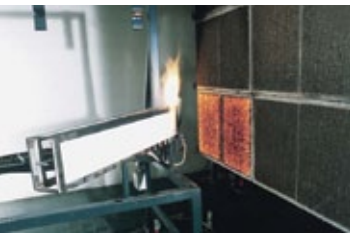
A1) Il calore di 750 C° del pannello radiante incendia il film di vernice
