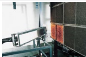
B3) La situazione è pressoché invariata, la zona danneggiata è minima e la fiamma tende a spegnersi.
